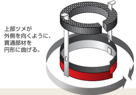
注記 貫通部材は必ず継手を組付ける前に取り付けてください。
